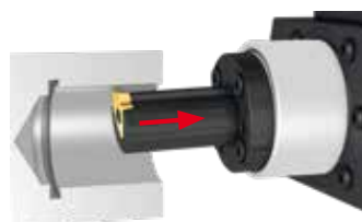
4 Функция отвода дер- жавки предотвращает износ и выкрашивание режущих кромок пла- стины при обратном ходе
