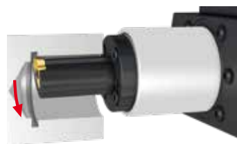
3 Державка отводится от заготовки
