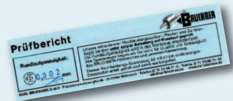
Prüftabelle „Rundlaufgenauigkeit“ am Beispiel Typ S, SG
