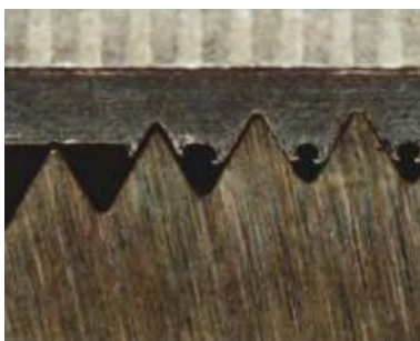
Пример формирования резьбы раскатником
