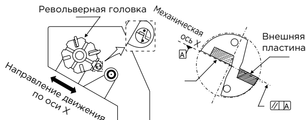
Рис. 1. Схема установки на токарном станке
