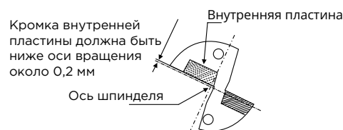
Рисунок 4. Сверло, вид спереди
